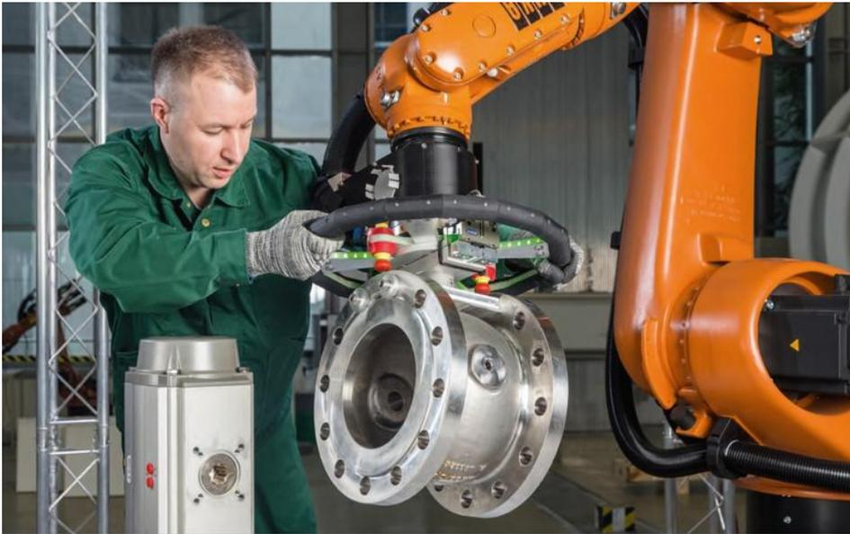
**Abbildung 1.1** Handführung im Bereich Montage von Schwerlasten
