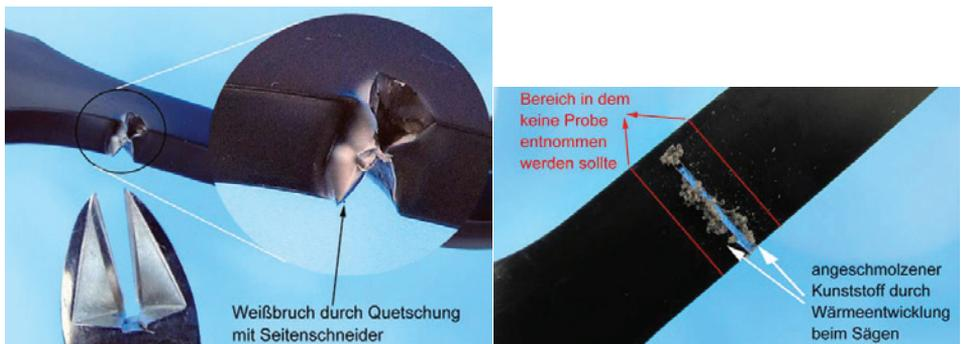
**Bild 3.6** Schädigung von Kunststoffproben bei der Probenentnahme
