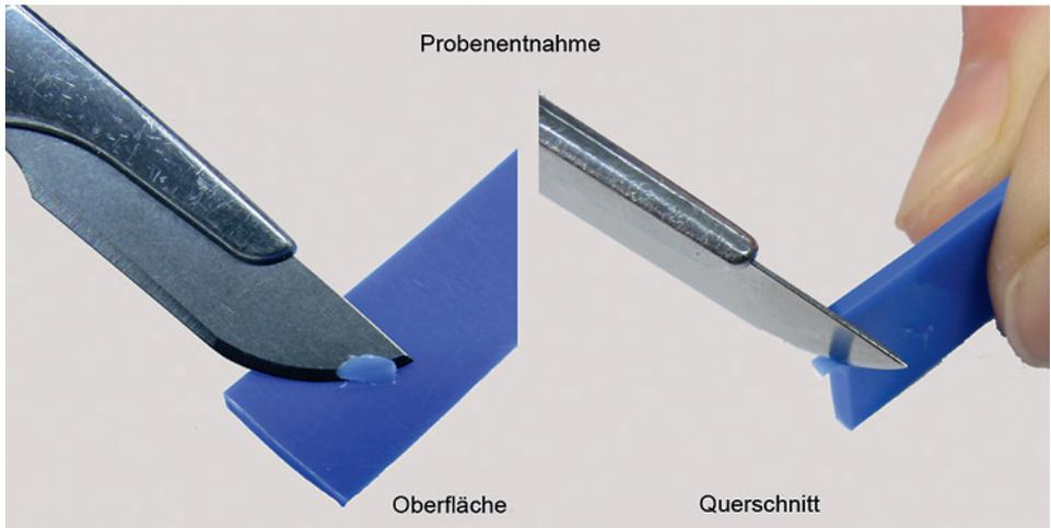
**Bild 3.4** Gezielte Wahl der Entnahmestelle der Probe
