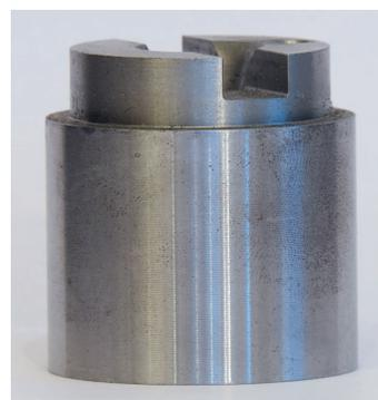
**Bild 4-3.7** Nockenwellenendstück (Stahlsorte: 44SMn28)
