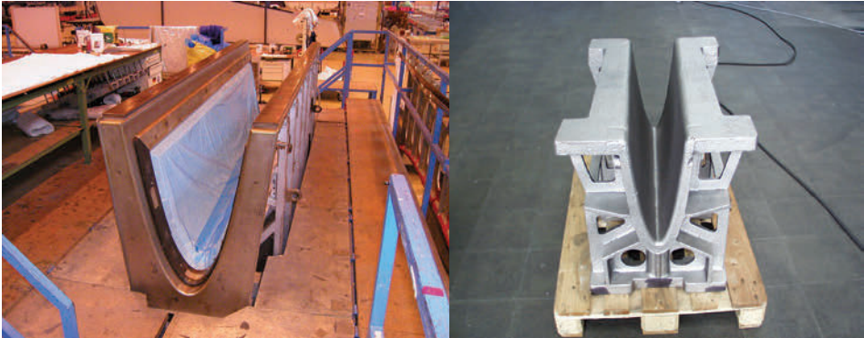
Bild 6.6 Nickel-Galvano-Tooling (links) und Nickelguss-Tooling (rechts) [Bildquelle: Premium Aerotec GmbH]
