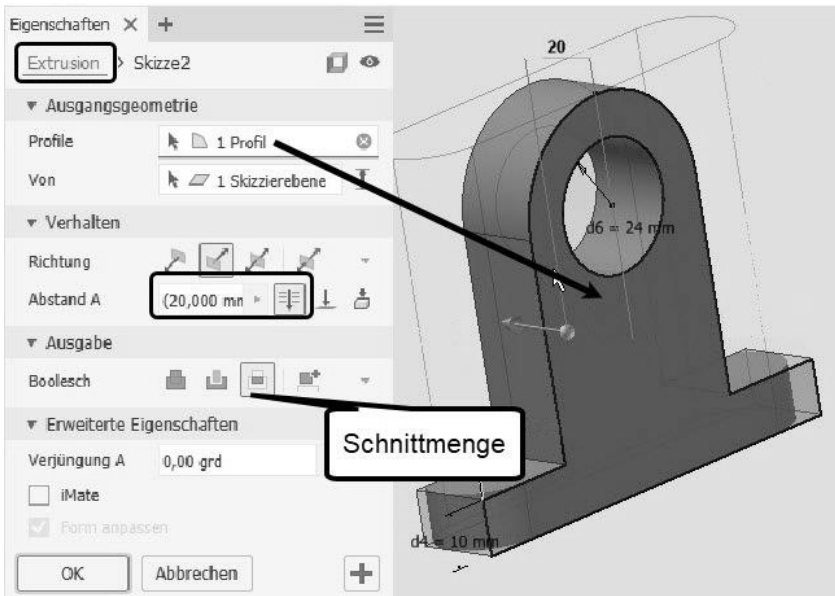
Abb. 1.36: Extrusion des zweiten Profils, Zusammenfügung mit der ersten Extrusion mit der Operation SCHNITTMENGE
