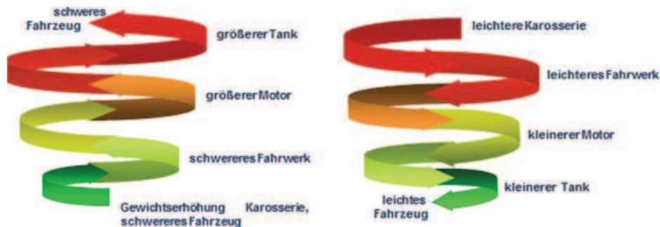
Abb. 2.12 Gewichtsspirale in der Fahrzeugentwicklung. Links Aufwärtsspirale; Rechts Abwärts-spirale durch Einsatz von Leichtbau
