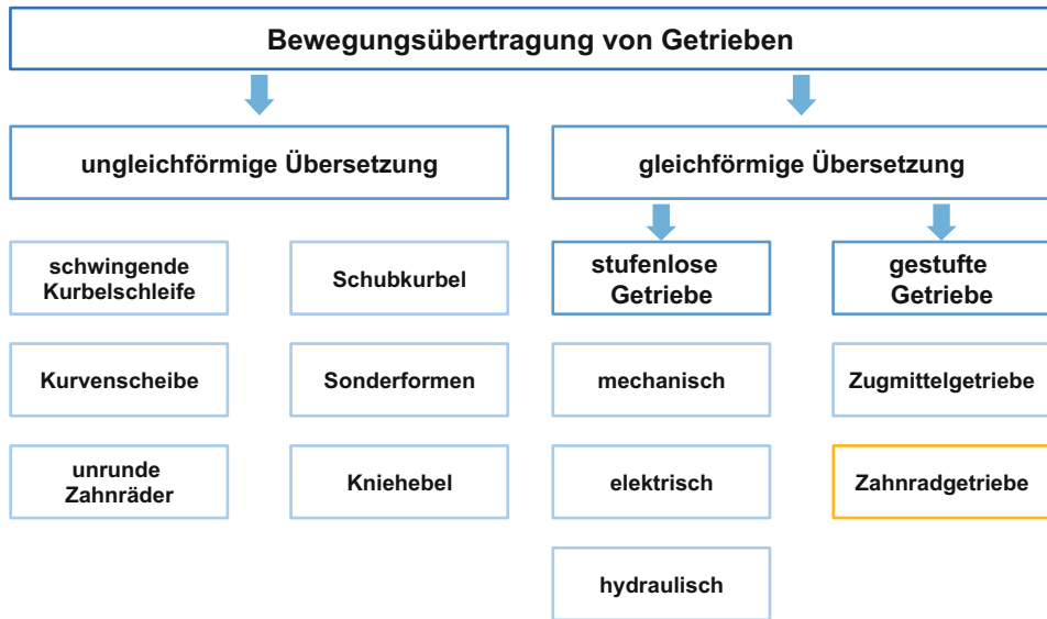
Bild 1.3 Einteilung der Getriebe nach Form der Bewegungsübertragung
