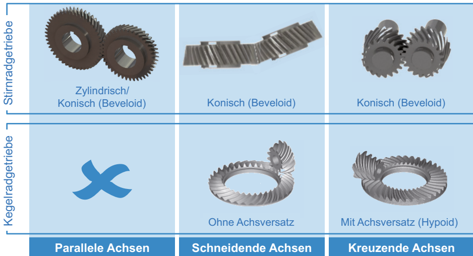
Bild 2.1 Grundformen von Zahnradgetrieben
