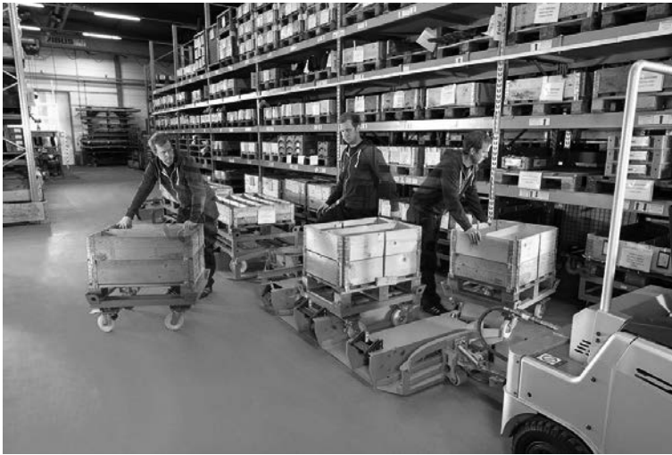
Bild 6.6 Routenzug bei der Be- und Entladung (Quelle: Still GmbH)
