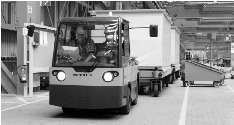
Bild 6.5 Schlepper im Einsatz (Quelle: Still GmbH)
