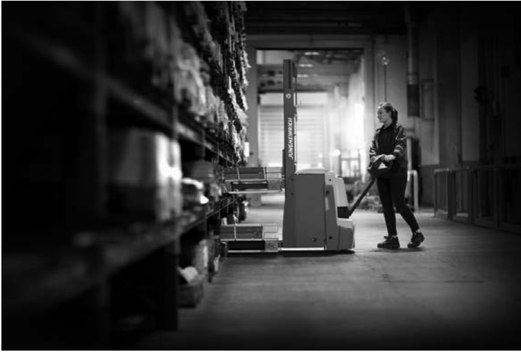
Bild 6.7 Gabelhochhubwagen im Einsatz (Quelle: Jungheinrich AG)
