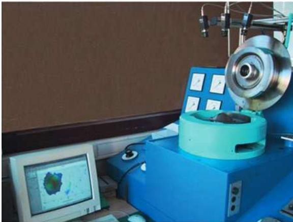
ERICHSEN – Prüfgerät mit VIALUX – Messkopf und Rechentechnik zur Aufnahme von Grenzformänderungsdiagrammen
