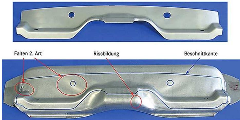
Heckteil „oben“ aus RA-k 40/70 (TRIP-Stahl 700),  $s = 0,8$  mm, erste Umformstufe
