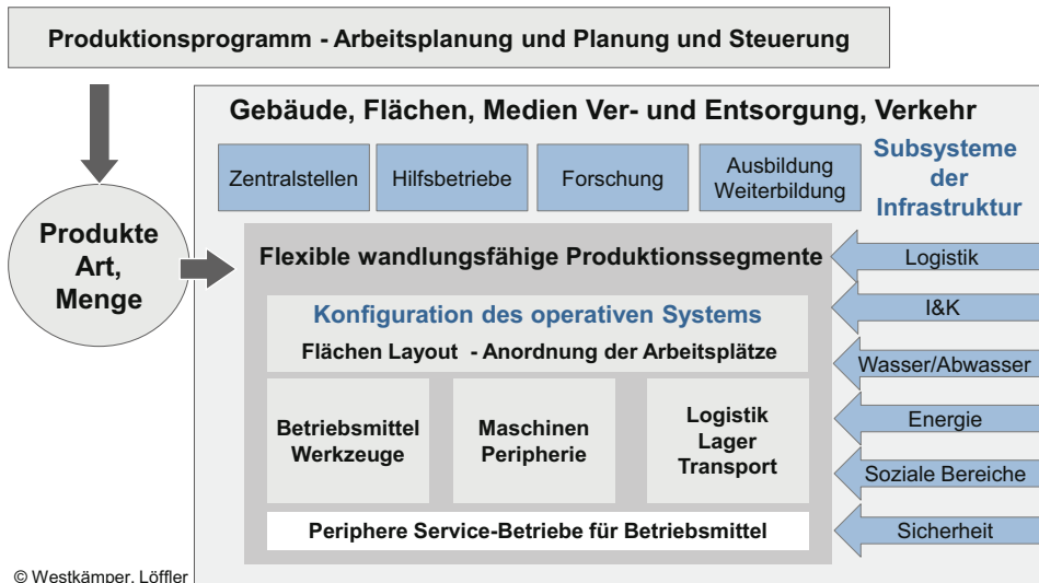
Abb. 6.23 Standort-Infrastruktur für die Produktion
