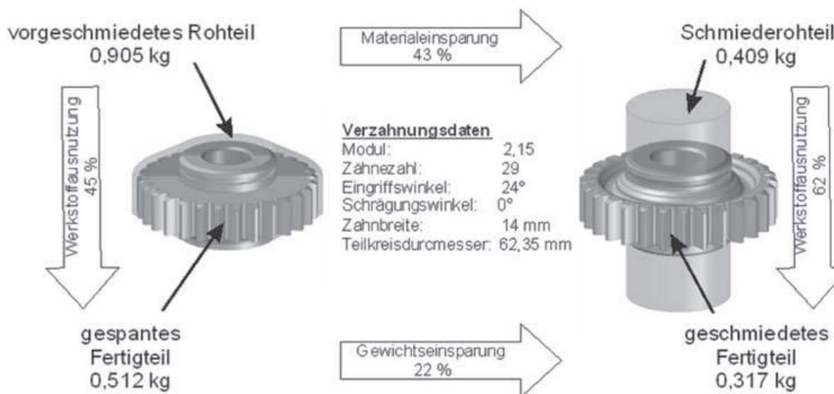
Abb. 2.1 Zahnradrohling geschmiedet aus dem Vollen gefräst [Lao97]
