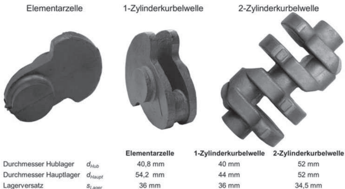
Abb. 2.4 Elementarzelle, 1- und 2-Zylinderkurbelwelle
